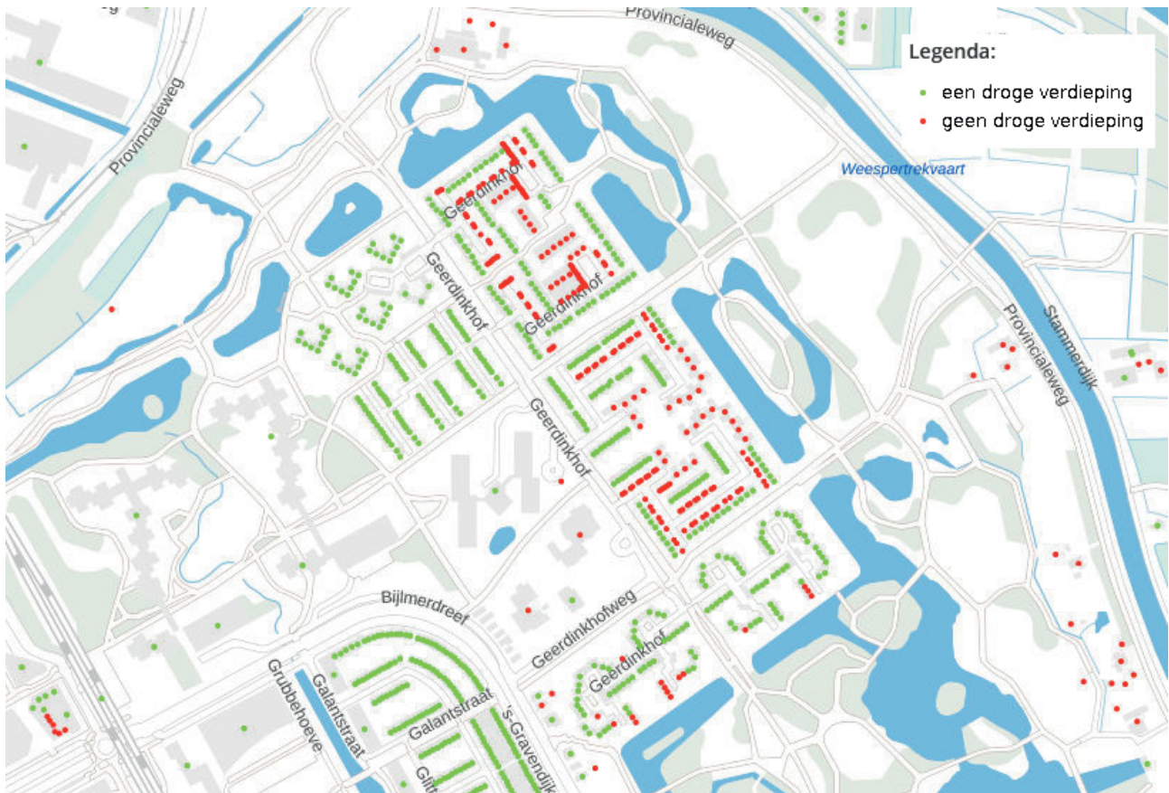
Afb. 1 - Op deze kaart staan de huizen in Geerdinkhof. Een groen stipje staat voor een plek met minstens één droge verdieping. Een rode stip heeft geen droge verdieping bij een maximale overstroming. De kaart van Rijkswaterstaat is een combinatie van de maximale overstromingskaart en het actuele hoogtebestand.
